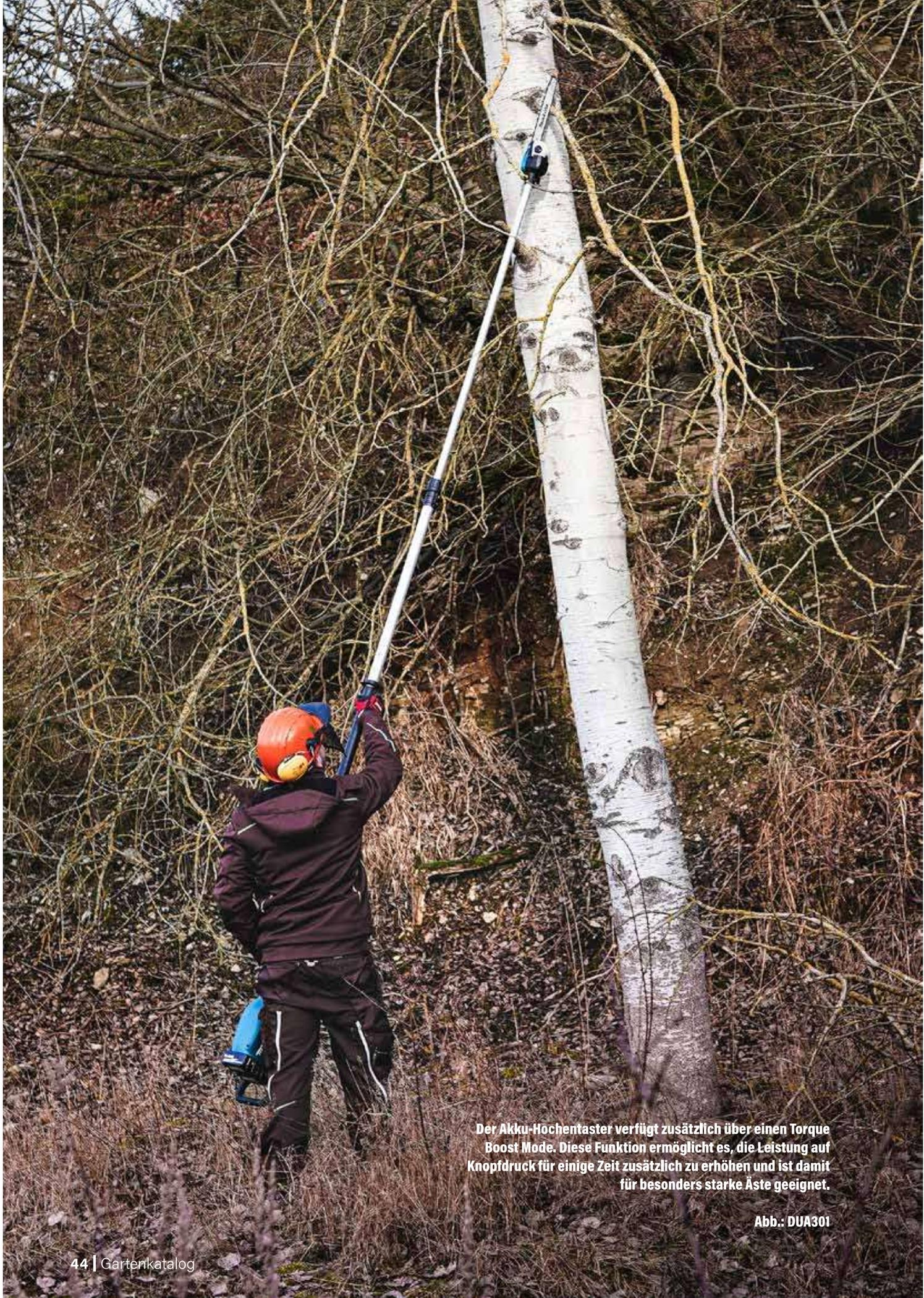
**Der Akku-Hochentaster verfügt zusätzlich über einen Torque Boost Mode. Diese Funktion ermöglicht es, die Leistung auf Knopfdruck für einige Zeit zusätzlich zu erhöhen und ist damit für besonders starke Äste geeignet.**
