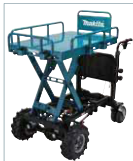
Elektrischer Lift. Höhenverstellbar von 475 bis 1020 mm
